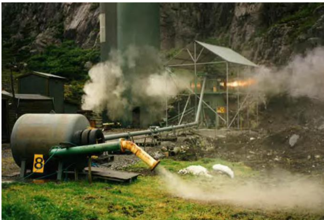
Figur 26. Försökupställning med slangfilter, 22 m kanal och ett mottagande kärl.
