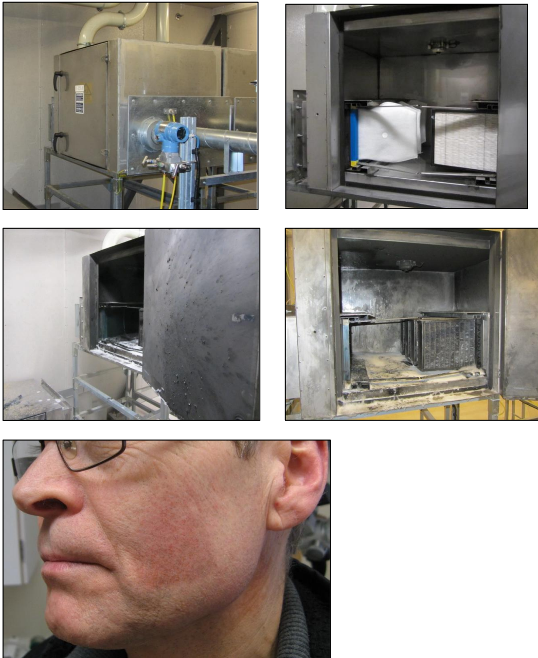
Figur 15. Foton som visar filterskåpen utvändigt (överst), efter incidenten (mellan) samt brännskada på operatören.
