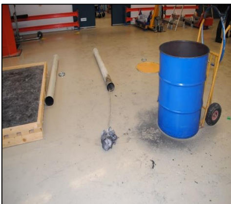
Figur 14. Rengöring av ventilationskanal som orsakade en antändning.
