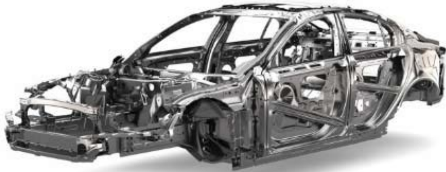
Jaguar XE monocoque chassis frame
